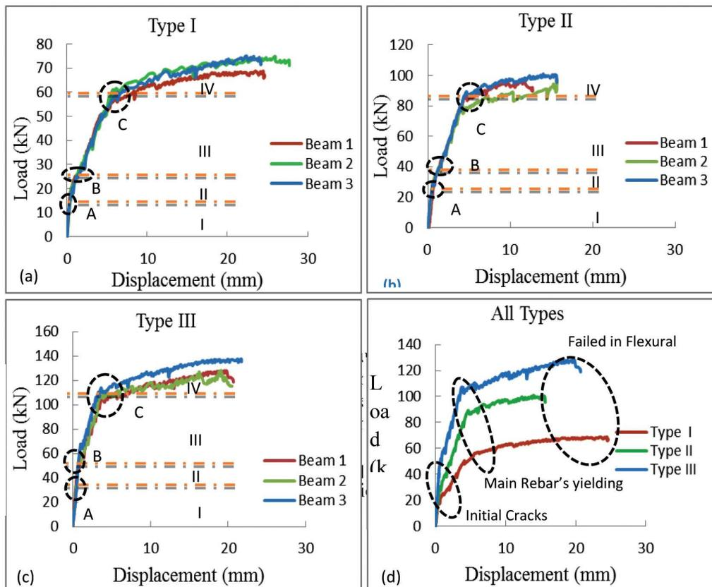
Figure 5. Load-displacement: (a) Type I, (b) Type II, (c) Type III and/ (d) All Types
